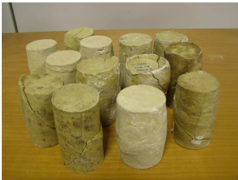
Figura 3.3. Provini triassiali portati a rottura.
